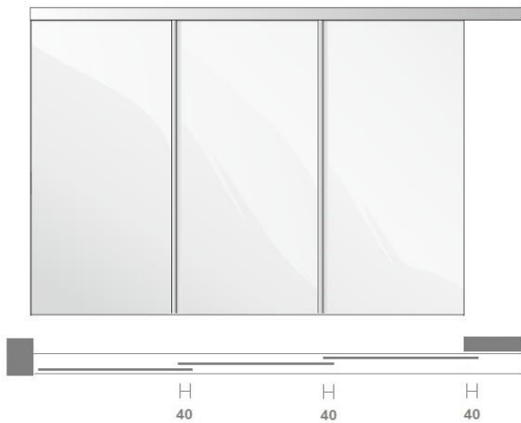
схема 3-3 без декоративной планки (расчет указан для ширины стекла до 1000 мм)
