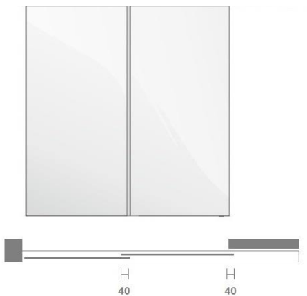
схема 3-1 без декоративной планки (расчет указан для ширины стекла до 1000 мм)
