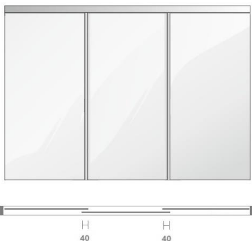
схема 3-2 без декоративной планки (расчет указан для ширины стекла до 1000 мм)
