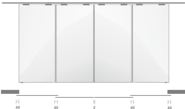
схема 4 - 1 с декоративной планкой (расчет указан для ширины стекла до 1000 мм)
